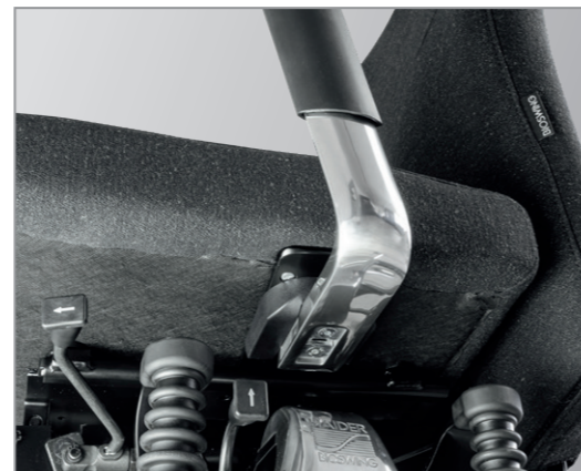
Armlehnen 1F mit Verstärkung und Polyurethan-Hartschaumauflage
